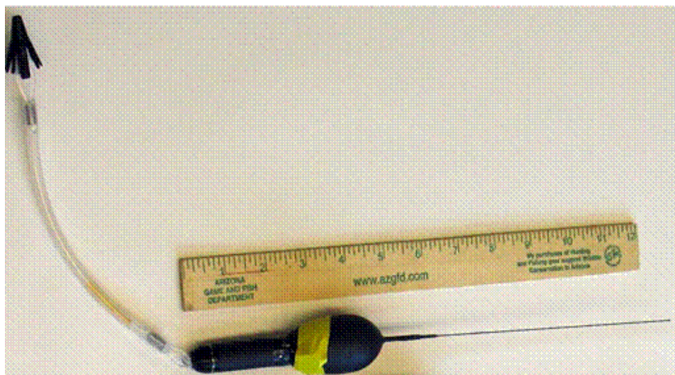
Figura E6. X-Tag con sistema de inserción tipo “umbrella” (Gentileza Dra. Lutcavage, Larger Pelagics Research Center)
