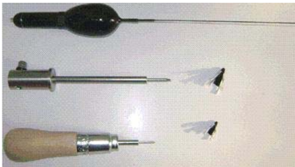
Figura E12. Etiqueta electr3nica X-tag, aparatos de inserci3n y dardos “M” y “S”. Para ello, se desarrollaron las siguientes actividades:
