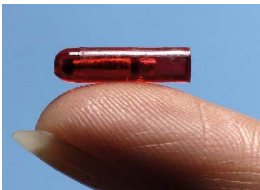
Figura E1. PIT tags implantable de plástico distribuido por Hallprint's.
