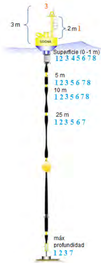
Figura 16. Esquema general de las estaciones de monitoreo oceanográfica y costera. En naranja se muestran las variables meteorológicas (1: temperatura, 2: presión atmosférica, 3: viento (magnitud, dirección), 4: radiación solar, 5: precipitación), y en celeste se muestran las variables oceanográficas (1: temperatura, 2: conductividad/salinidad, 3: presión/profundidad, 4: corrientes, 5: fluorescencia, 6: turbidez, 7: oxígeno disuelto, 8: pH). Además se presentan las profundidades/alturas, en metros, a las que debe ser medida cada variable señalada.
