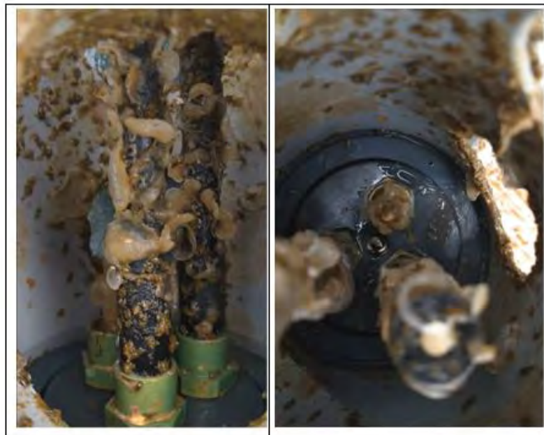
Figura 71. Estado de sensores y equipos de la estación ubicada a 10 m de profundidad en el momento de ser retirada.
