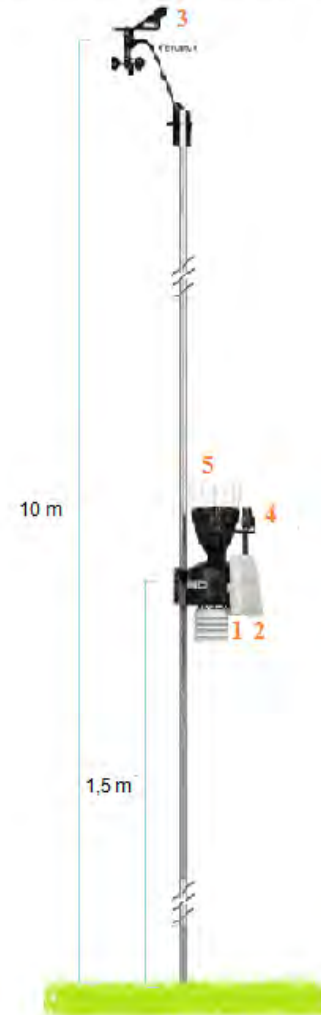
Figura 16. Esquema general de las estaciones de monitoreo oceanográfica y costera. En naranja se muestran las variables meteorológicas (1: temperatura, 2: presión atmosférica, 3: viento (magnitud, dirección), 4: radiación solar, 5: precipitación), y en celeste se muestran las variables oceanográficas (1: temperatura, 2: conductividad/salinidad, 3: presión/profundidad, 4: corrientes, 5: fluorescencia, 6: turbidez, 7: oxígeno disuelto, 8: pH). Además se presentan las profundidades/alturas, en metros, a las que debe ser medida cada variable señalada.
